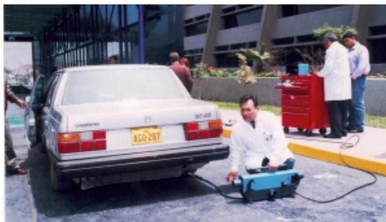
Vehículo con motor diesel: Medición con opacímetro. SENATI.
